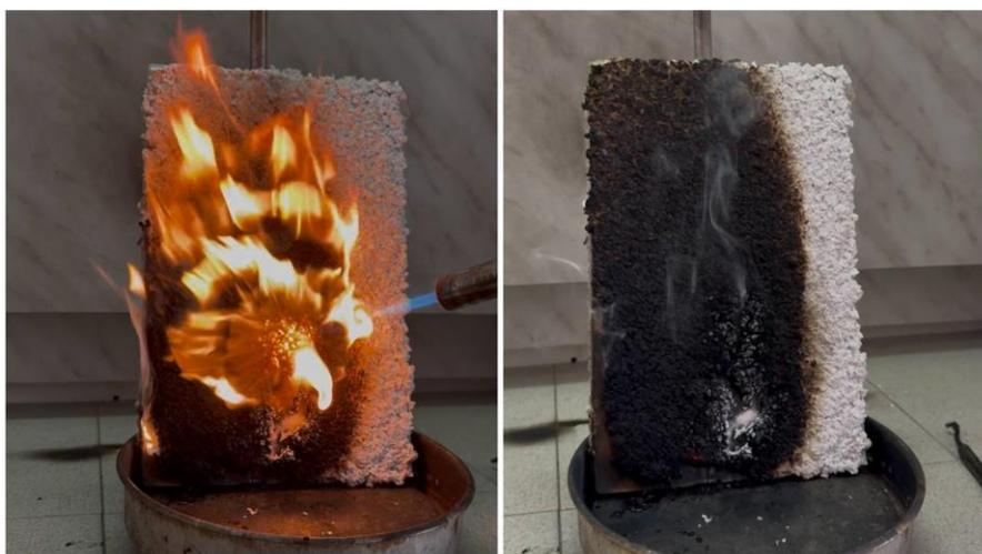
**Рис. 5.** Воздействие открытого пламени газовой горелки на образцы
