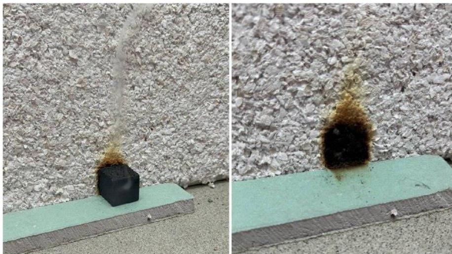
**Рис. 4.** Воздействие тлеющего кальянного угля на поверхность исследуемого материала
