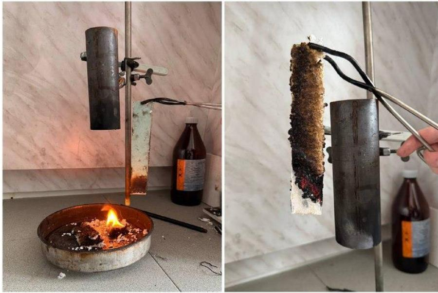
**Рис. 3.** Внешний вид образцов гипсокартона с нанесенным на их поверхность слоем жидких обоев после испытания по методу «огневой трубы»
