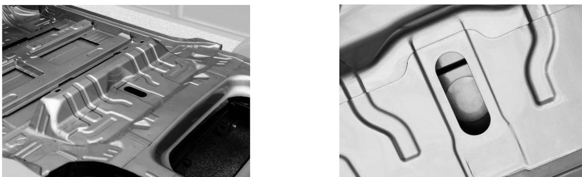
**Рис. 3.** Пожарный лючок с термочувствительными элементами
