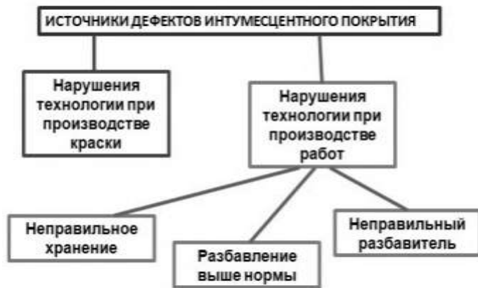
Рисунок 4 – Причины нарушения качества интумесцентной огнезащиты
