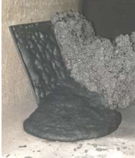
Рисунок 7 – Влияние избыточного разбавления на свойства ПК (справа модельный состав краски + 10% разбавителя, слева краска «Defender M solvent» + 10% ортоксилола)
