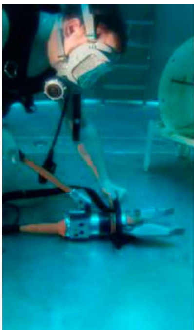
Рис. 4.6. Перекусывание арматуры при помощи РКГм 63.
