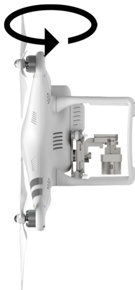
Рис. 9.2. Вращение БВС в вертикальном положении
