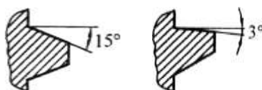
Рис.2.10 Виды сечений витка резьбы.
