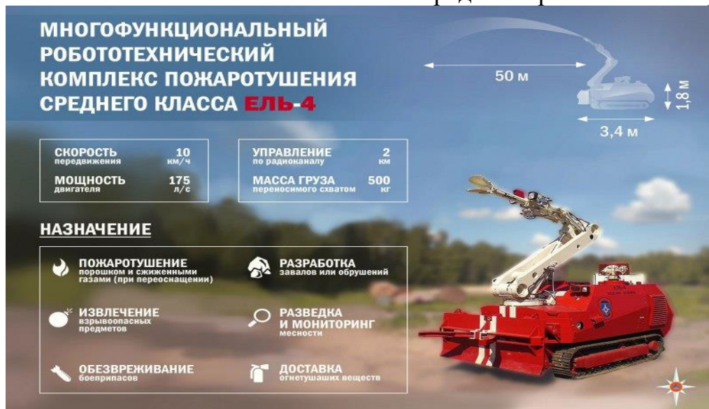
Рис. 1. Технические характеристики РТК Ель-4
