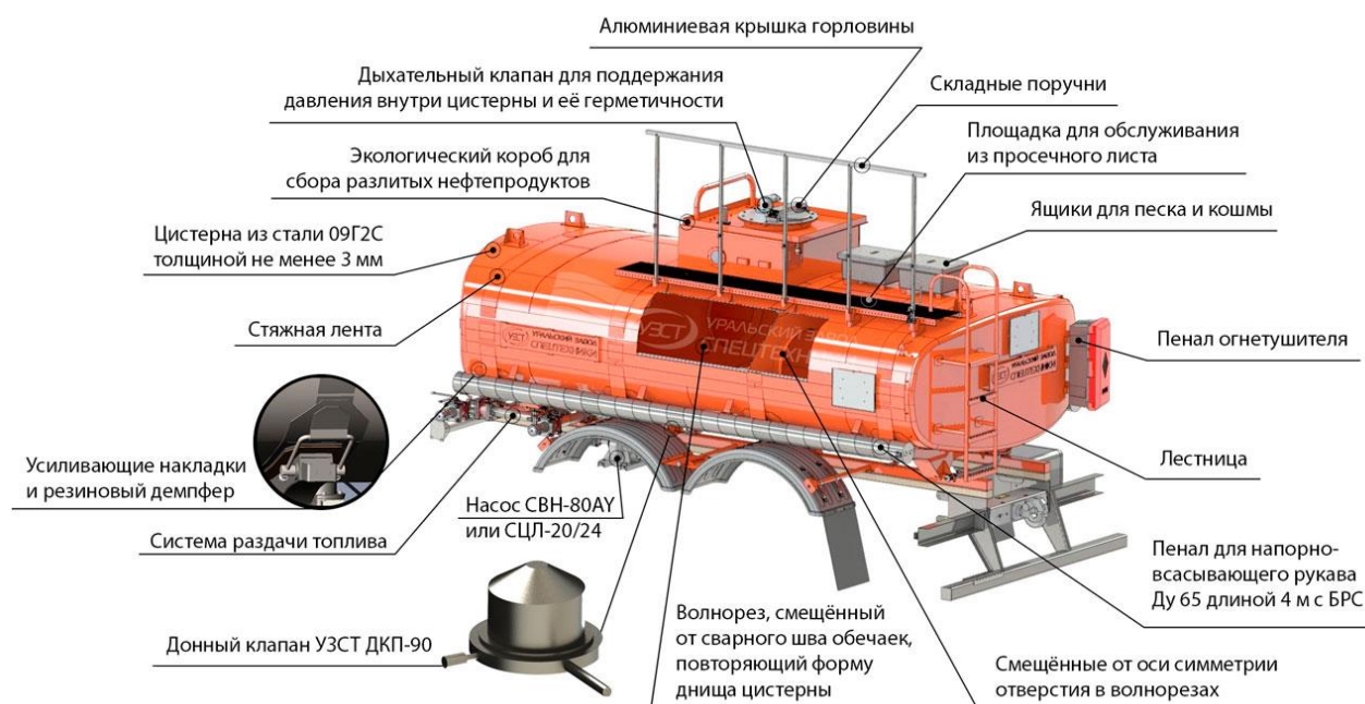
Рис. 2. Конструктивные особенности автоцистерны
