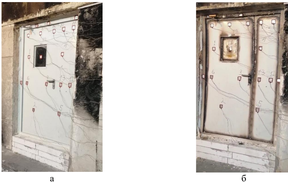
Рис. 1. Испытание противопожарной двери на огнестойкость а – в начале испытания, б – через 60 минут
