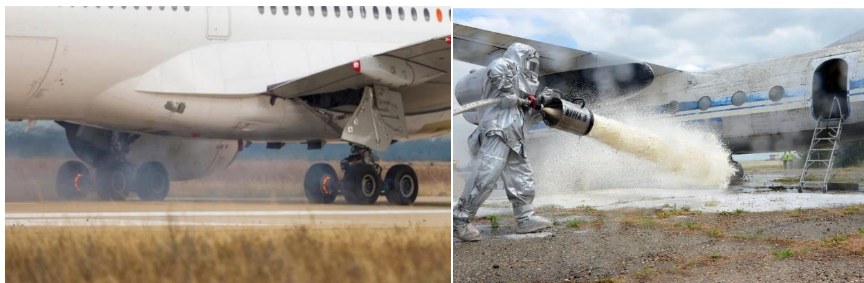
Рис. 5. Воспламенение магниевых сплавов тормозов ВС и процесс тушения пожара шасси
