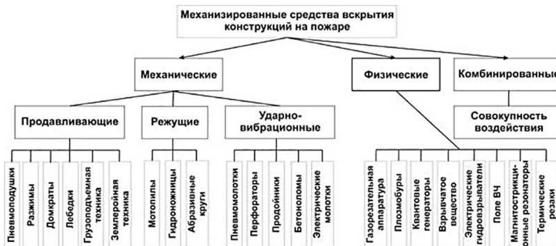
**Рис. 2.** Механизированные средства вскрытия конструкций на пожаре
