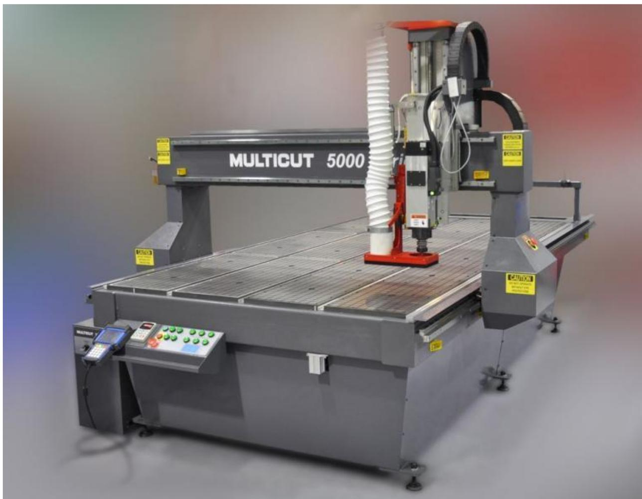
**Рис. 2.** Станок ЧПУ с вытяжкой
