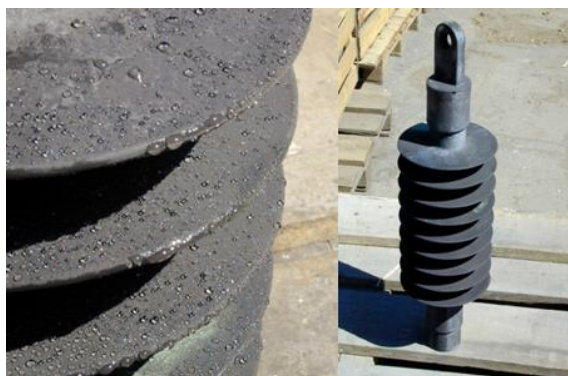
Рис. 1. Сохранение гидрофобности на слое загрязнения фиксаторного изолятора типа ФСПК-120-25/1.1 [5]
