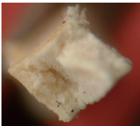
Рис. 3. Внешний вид структуры образца, выдержанного в уксусной кислоте, после разрыва, X20
