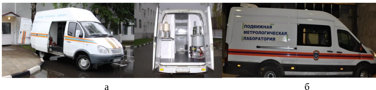
Рис. 1. Подвижная метрологическая лаборатория ФКУ «ЦБИТ МЧС России» а – на базе автомобиля ГАЗ 2705; б – на базе автомобиля «Ford transit»
