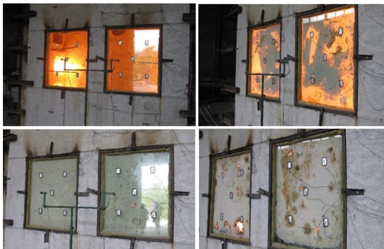
Рис. 5. Внешний вид образцов во время испытаний и после испытаний
