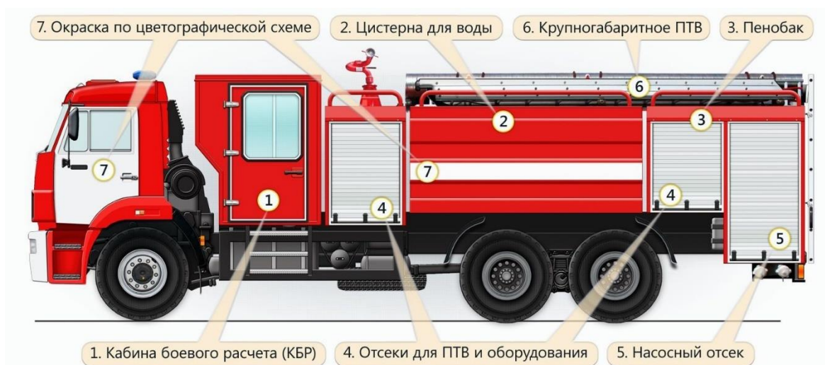
Рис. 1. Элементы АЦ: 1 — кабина боевого расчета; 2 — цистерна для воды; 3 — пенобак; 4 — отсеки для ПТВ и оборудования; 5 — насосный отсек; 6 — крупногабаритное ПТВ; 7 — окраска по цветографической схеме
