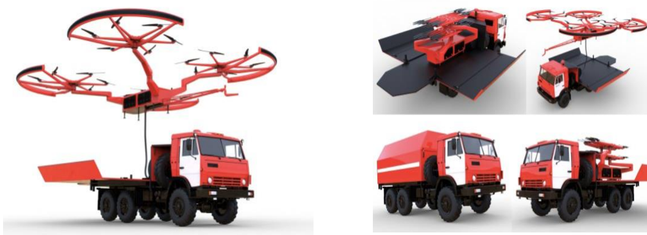
Рис. 3. Многоцелевая аэронесущая платформа с гибридной силовой установкой
