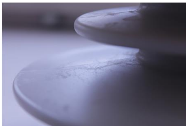
Рис. 4. Следы эрозии, распространяющиеся от шейки изолятора к его периферии
