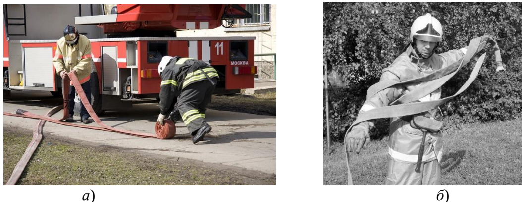
Рис. 1. Способы сбора рукавов после пожара: а — сбор рукава в двойную скатку; б — сбор рукава «восьмеркой»
