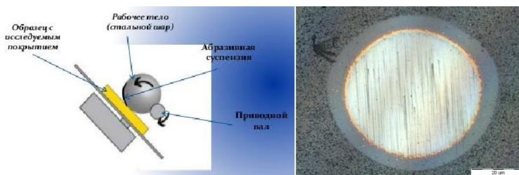
Рис. 1. Методика получения сферического шлифа: а – схема процесса; б – изображение шлифа, получаемое при помощи оптического микроскопа
