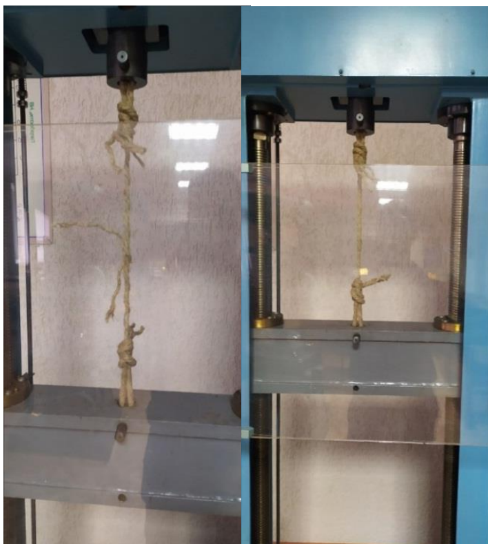
Рис. 2. Эксперимент с пеньковой веревкой
