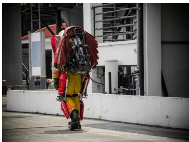
Рис. 2. Пожарный экзоскелет Auberon Pneumatic Exoskeleton, разработанный производителем автомобилей Trigen Automotive в Сингапуре
