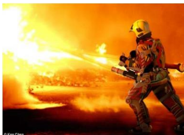
Рис. 3. Тушение пожара при помощи пожарного экзоскелета AFA, оснащенного стволом и рукавом высокого давления
