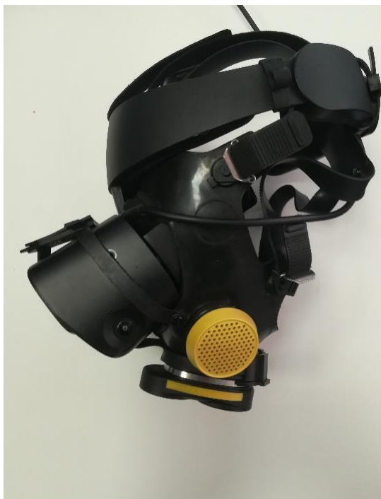
Рис. 1. Имитатор работы в СИЗОД
