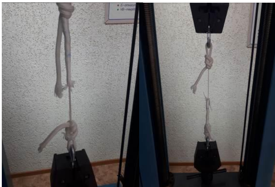
Рис. 4. Эксперимент с новой ВСП-30 (мокрая)
