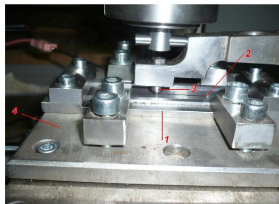
Рис. 2. Узел трения установки ТЛПТ-01: 1 – ванна со смазочным материалом; 2 – образец; 3 – контртело; 4 – нагреваемая плита
