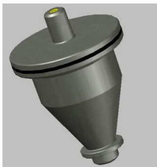
Рис. 1. Трехмерное изображение насадки для распыления огнетушащего вещества
