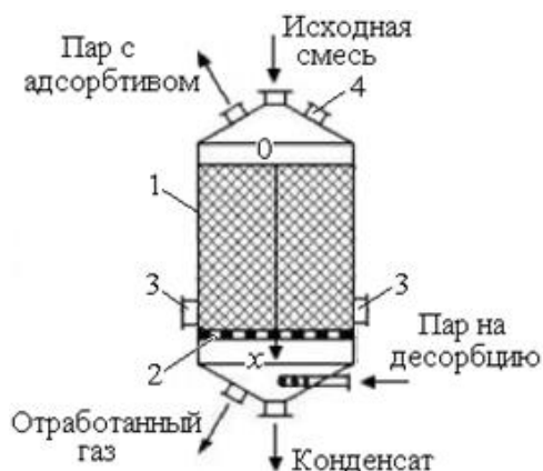
Рис. 1. Адсорбер с неподвижным слоем адсорбента: 1 – корпус, 2 – опорно-распределительная решетка, 3 – люк для выгрузки адсорбента, 4 – люк для загрузки адсорбента
