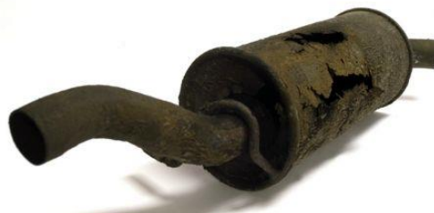
Рис. 2. Резонатор автомобиля, разрушенный вследствие газовой коррозии
