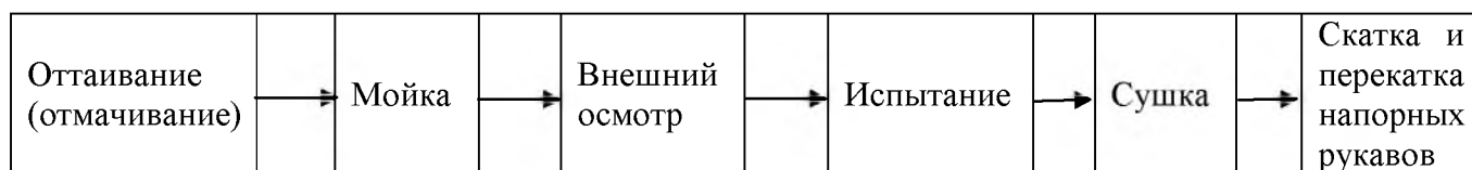
Рис. 1. Схема технического обслуживания пожарных рукавов
