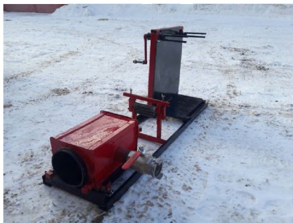
Рис. 2. Натурный образец мобильного комплекса для ТО пожарных рукавов
