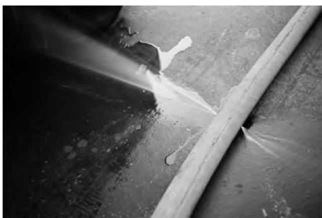
Рис. 3. Прорыв напорного пожарного рукава
