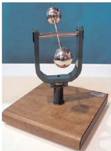
Рис. 4. Фрагмент видеоролика, демонстрирующего закон сохранения кинетического момента системы относительно вертикальной неподвижной оси, созданный на основе оборудования кафедры
