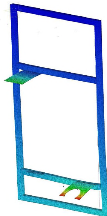
Рис. 3. Картина распределения деформаций по элементам конструкции рамы
