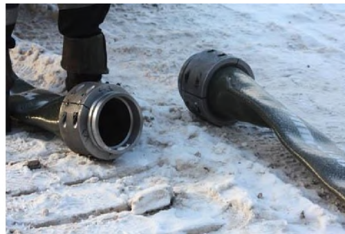
Рис. 4. Процесс соединения полугаек
