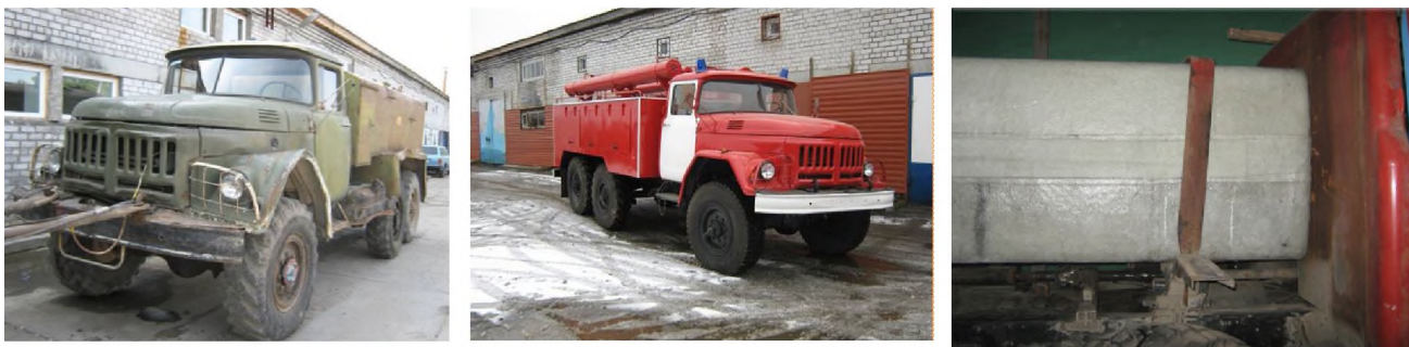
Рис. 1. Пример модернизации специального автомобиля на шасси ЗИЛ-131 в пожарную автоцистерну с установкой цистерны из стеклопластика
