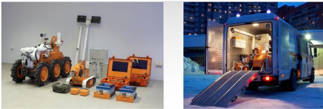
Рис. 4. Робототехнический комплекс предназначен для радиационной и химической разведки
