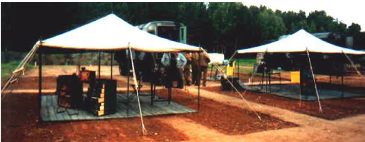
Рис. 4. Передвижная ремонтно-химическая мастерская ПРХМ-1М в развёрнутом виде
