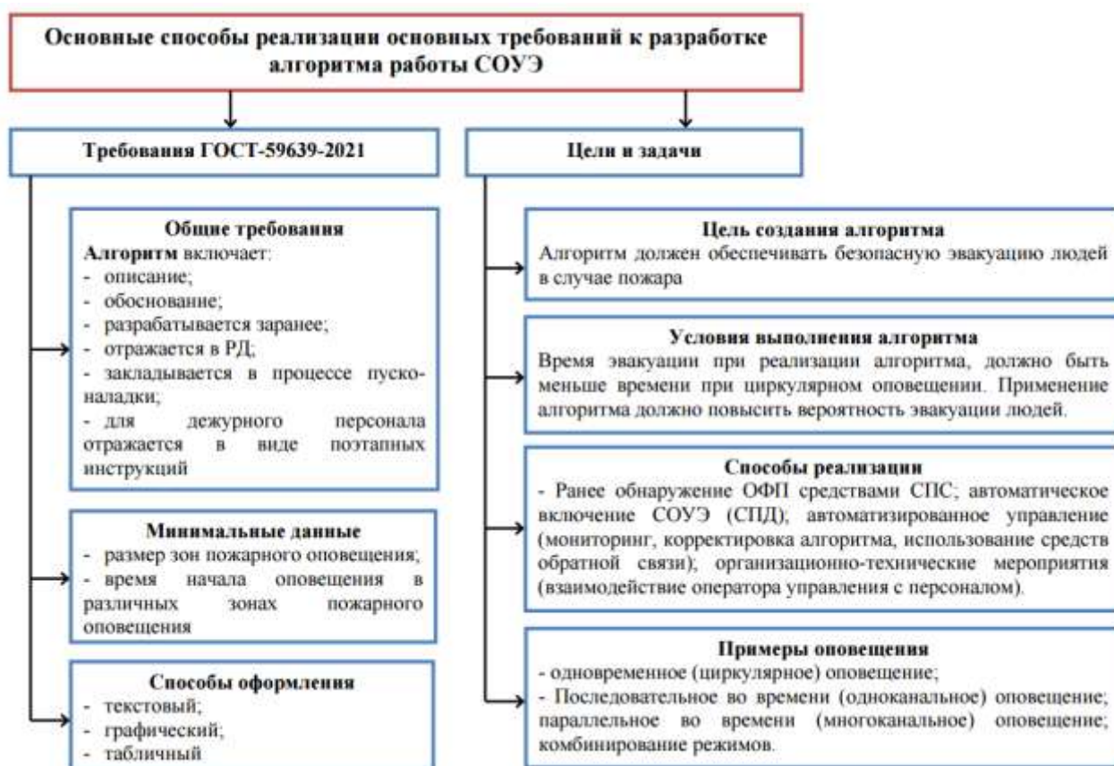
Рисунок 3.8 – Нормативные требования и способы реализации алгоритмов работы СОУЭ
