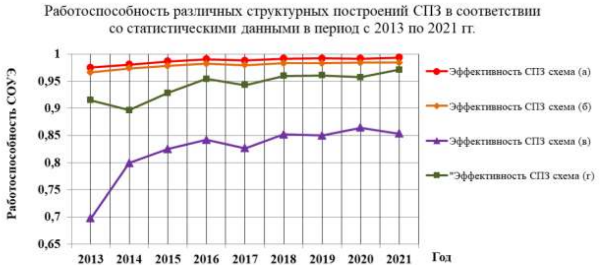
Рисунок 4.7 – Работоспособность различных структурных построений СПЗ в соответствии со статистическими данными в период с 2013 по 2020 г.
