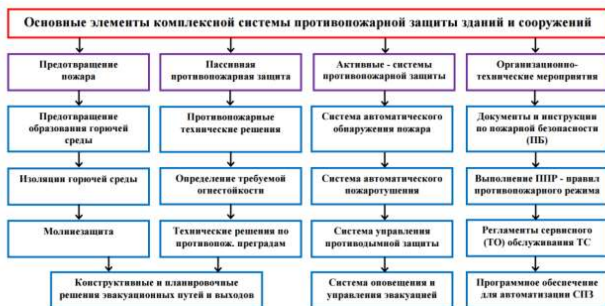
Рисунок 1.4 – Основные элементы комплексной системы противопожарной защиты зданий
