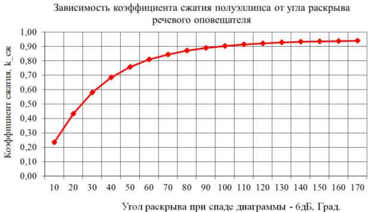
Рисунок 2.3 – Зависимость коэффициента сжатия полуэллипса для одной плоскости, от ШДН РО
