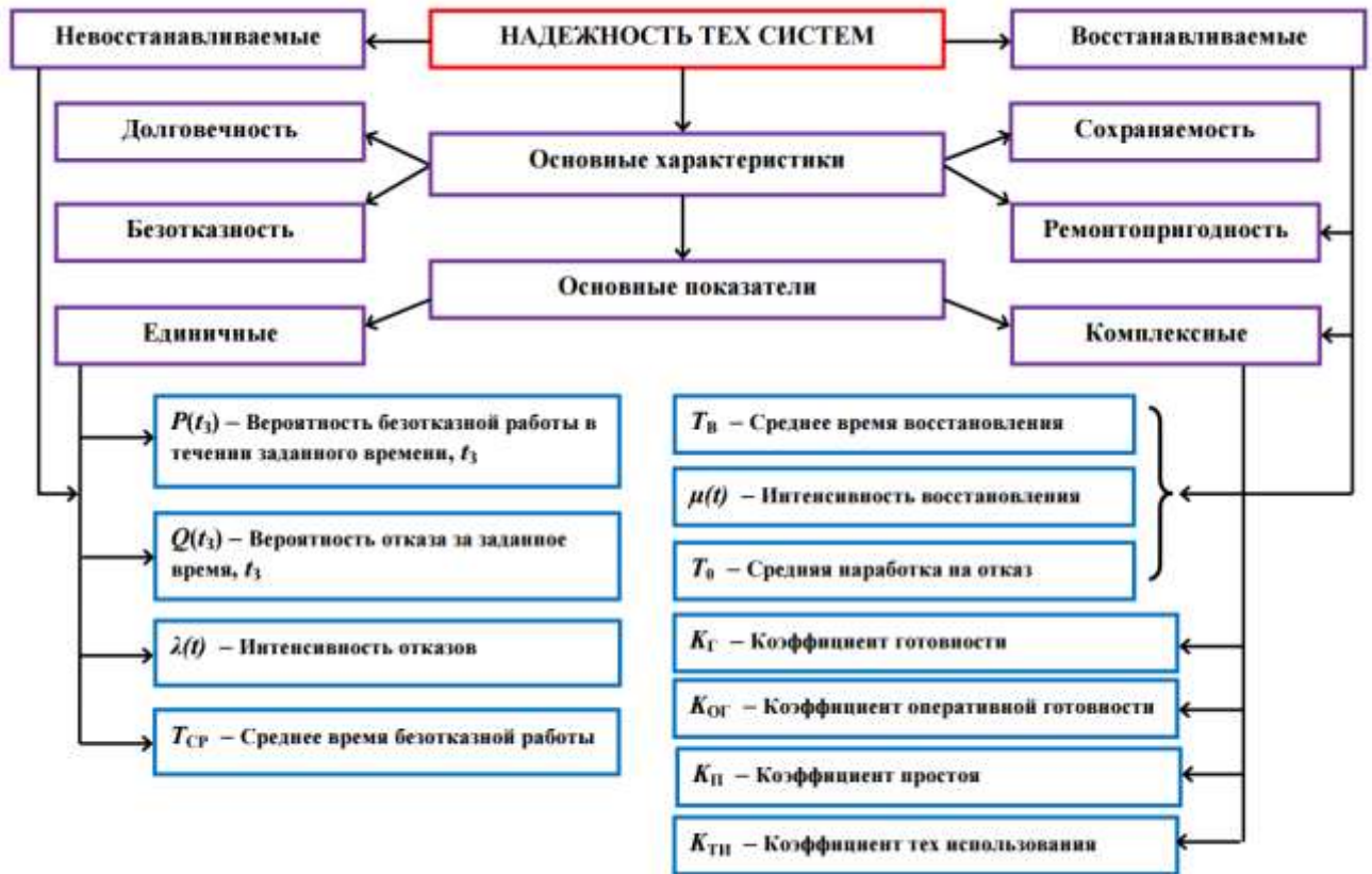
Рисунок П4.1 – Основные показатели надежности технических радиоэлектронных систем
